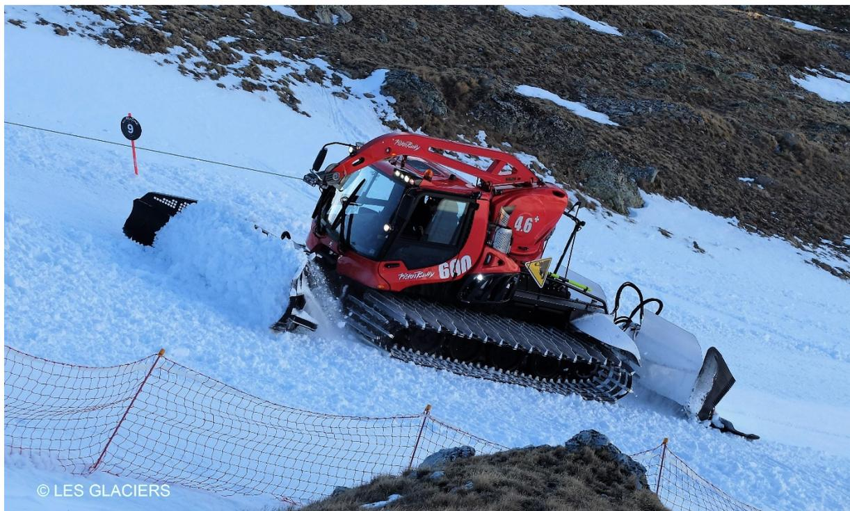
Avec sa lame de plus de 5 mètres excessivement maniable, activée à l'aide de 9 pistons hydrauliques, elle remonte et nivèle la neige déplacée par les skieurs. De même les flaps mobiles latéraux aident à rabattre la neige perdue sur les côtés vers le centre de la piste.
